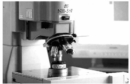
图 3 超精密 3D 激光检测仪
